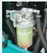
Voorfilter met ingebouwde waterafscheider
