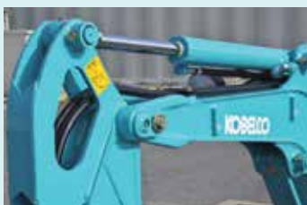
Slangen bakcilinder lopen door graafarm
